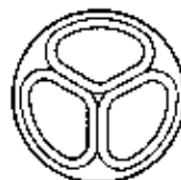
se = сплошная однопроволочная секторная жила
