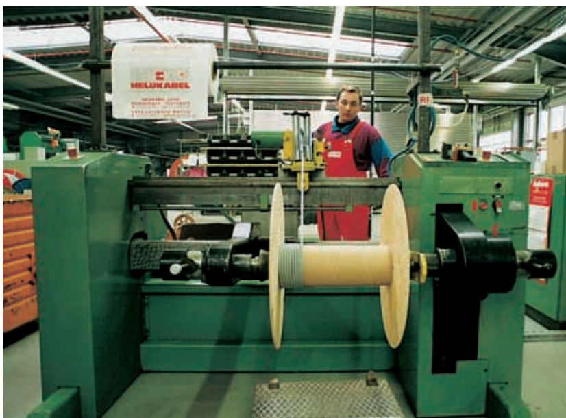
Процесс намотки на заводе Windsbach
