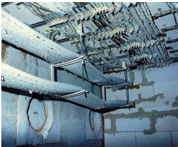
После теста на пожаростойкость.
