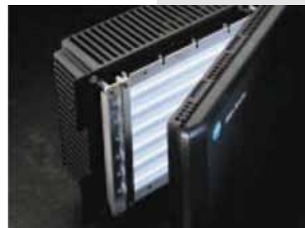
PanelView 600, 900 и 1000 с цветными дисплеями имеют патентованную заменяемую в полевых условиях подсветку.
