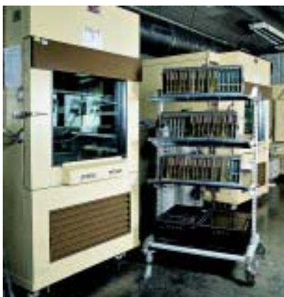
Sepam в камере температурных и вибрационных испытаний
