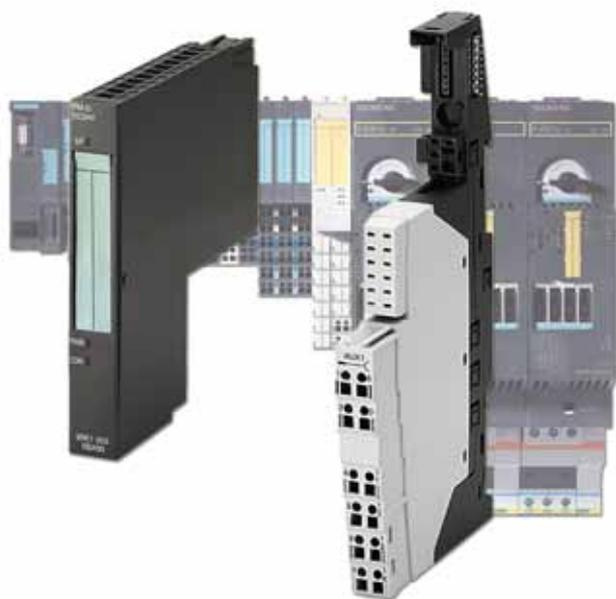
Модуль PM-D предназначен для мониторинга напряжения питания цепей электроники  $U_1$  (PWR) и обмоток контакторов  $U_2$  (CON) силовых модулей станции ET 200S. Он устанавливается на терминальный модуль TM-P15S27-01, формирует потенциальную группу силовых модулей и поддерживает выполнение диагностических функций. Исчезновение напряжения питания или перегорание предохранителя сопровождается формированием сообщения для ведущего сетевого устройства, а также включением светодиодной индикации.
