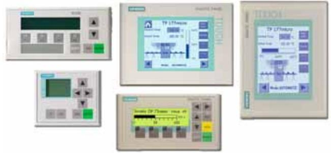
MATIC WinCC flexible 2005 Micro. Все микро панели обеспечивают поддержку кириллицы.
