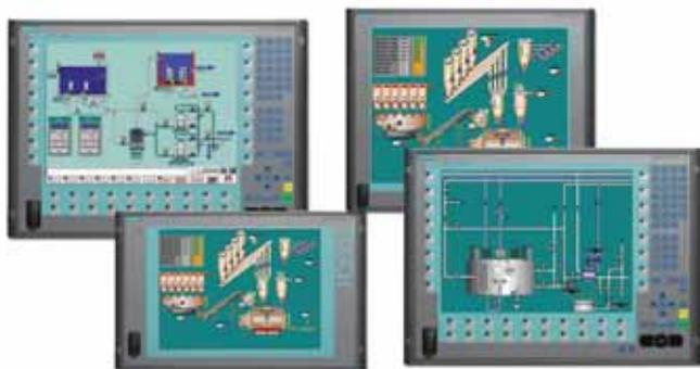
SIMATIC Panel PC – это семейство промышленных компьютеров, предназначенных для решения задач визуализации, оперативного управления и мониторинга. Они могут встраиваться в пульты и стойки управления, монтироваться непосредственно на автоматизируемых машинах. SIMATIC Panel PC являются идеальной платформой для систем визуализации и оперативного управления на основе SIMATIC WinCC flexible Advanced и SIMATIC WinCC, а также систем компьютерного управления SIMATIC WinAC.
