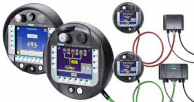
Переносные панели, позволяющие выполнять функции оперативного управления и мониторинга из различных точек предприятия. Панели серии 177 снабжены 5.7" STN CCFL сенсорным графическим дисплеем и мембранной клавиатурой. В панелях серии 277 используется 7.5" сенсорный графический TFT дисплей и мембранная клавиатура.
