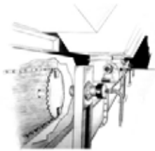
Измерение числа оборотов на вращающемся валу шлюзового затвора барабанного типа
