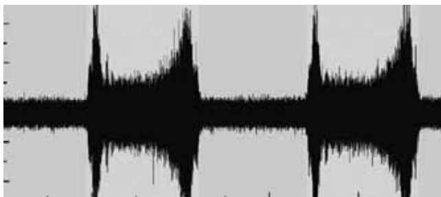
Сигнал сенсора шума при поврежденном клапане
